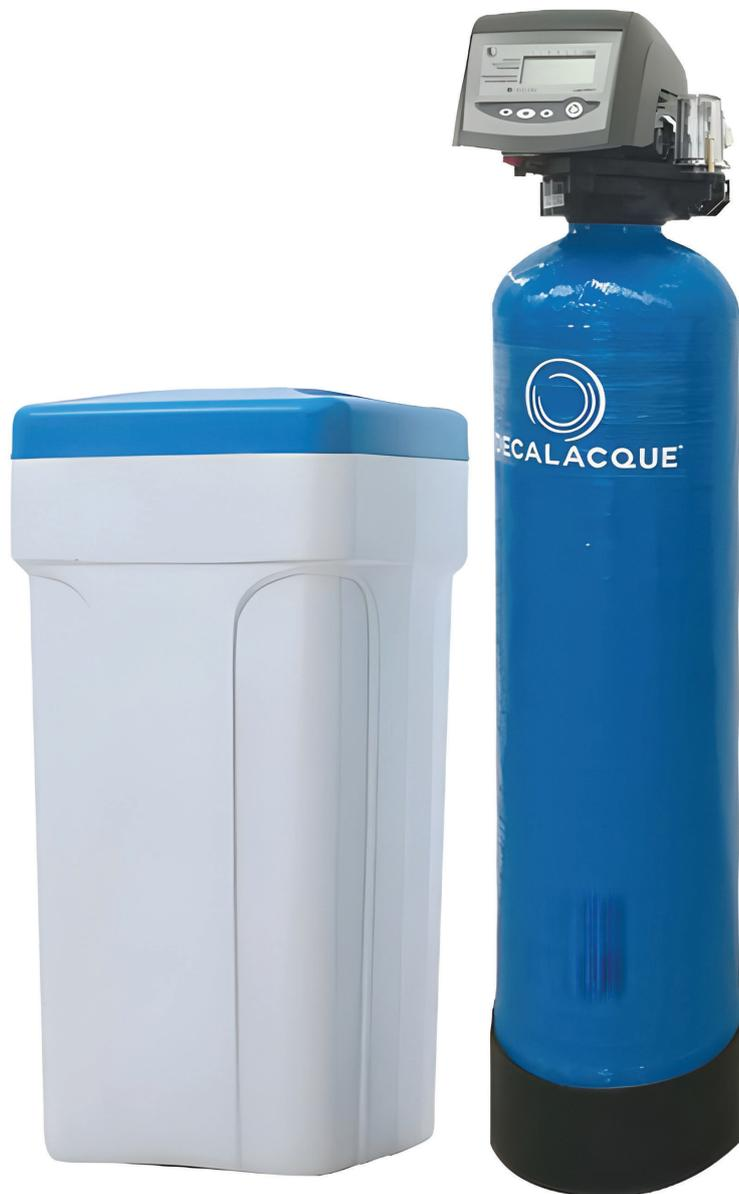
L'addolcitore riduce efficacemente il calcare dell'acqua e ne previene la sedimentazione nelle condutture idriche e sulle superfici, garantendo una portata d'acqua continua e costante. Tale risultato è ottenuto sostituendo gli ioni di calcio e magnesio, responsabili della formazione di calcare, con ioni di sodio che, al contrario, non tendono a precipitare nelle tubazioni.
