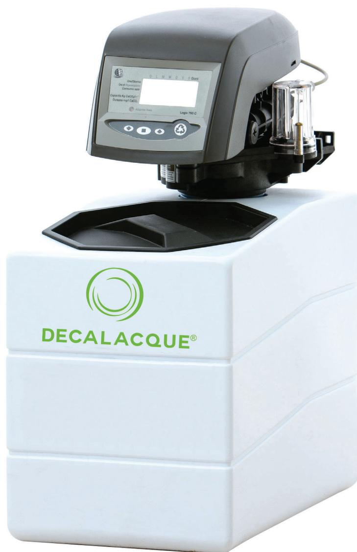
L'addolcitore riduce efficacemente il calcare dell'acqua e ne previene la sedimentazione nelle condutture idriche e sulle superfici, garantendo una portata d'acqua continua e costante. Tale risultato è ottenuto sostituendo gli ioni di calcio e magnesio, responsabili della formazione di calcare, con ioni di sodio che, al contrario, non tendono a precipitare nelle tubazioni.
